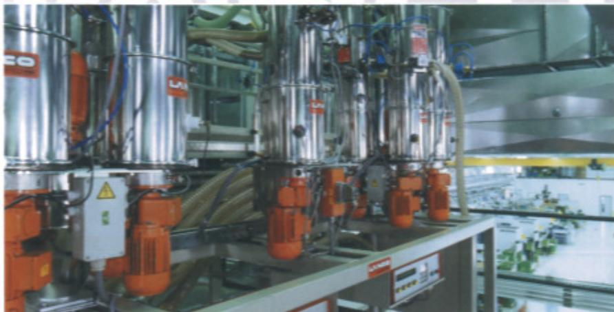
Moderne Verarbeitungsbetriebe benötigen Gesamtkonzepte für den automatischen Materialfluss vom Silo über die Trocknung und Aufbereitung hin zur Produktionsmaschine bei weitgehender Entlastung des Bedienungspersonals und mit Möglichkeit des Datenaustauschs über EDV. Da die Produktion nach Einführung eines umfassenden Fördersystems davon weitgehend abhängig wird, sind an die Verfügbarkeit und Betriebssicherheit einer solchen Anlage höchste Anforderungen zu stellen.
